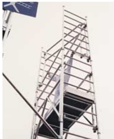
Figure 2. Échafaudage roulant en hauteur
